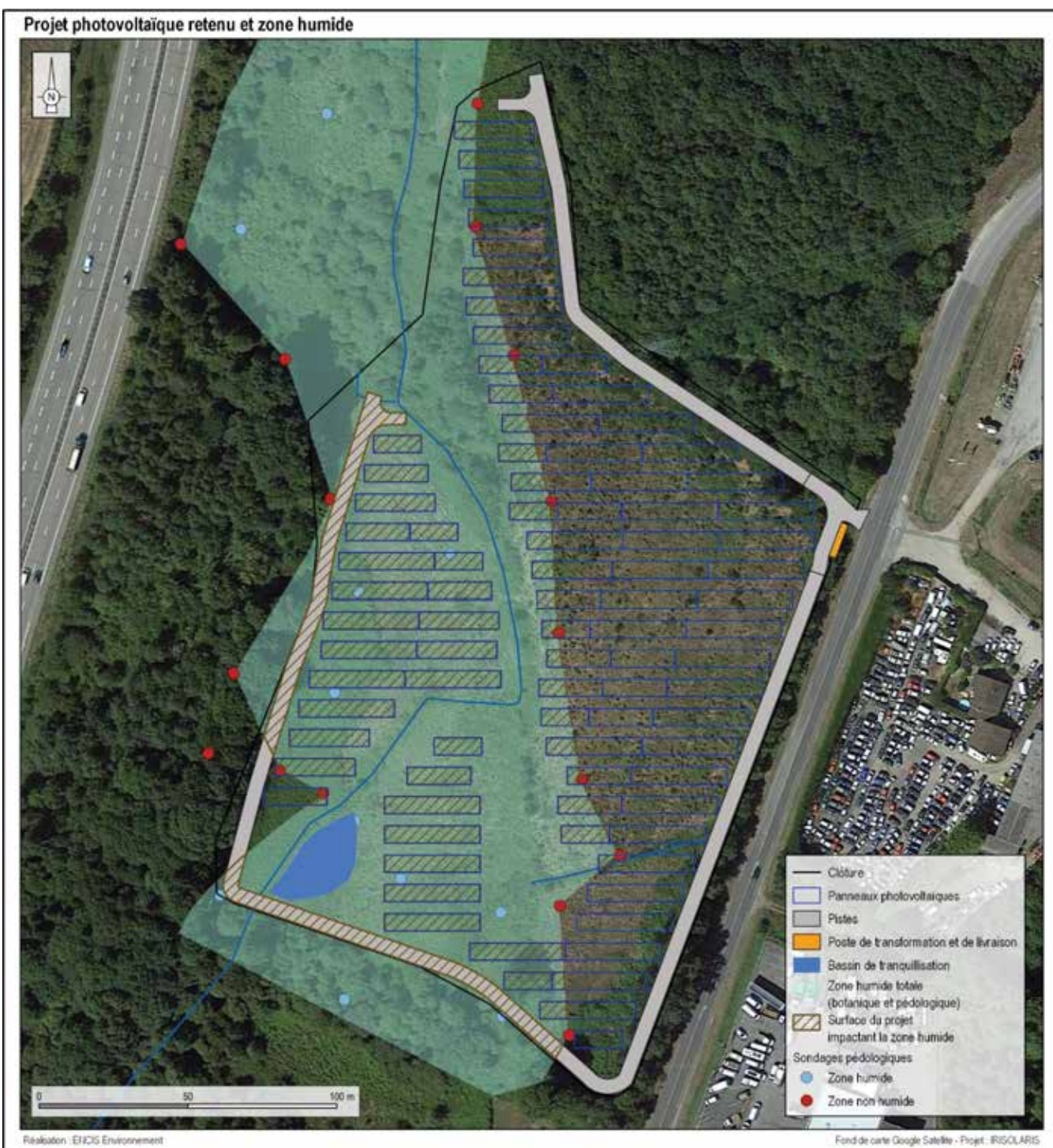
Carte 25 : Projet photovoltaïque retenu et zone humide
