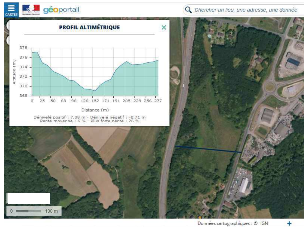
Figure 3 : Profil topographique depuis la RD vers l'autoroute, profil Est-Ouest (rapport d'échelle augmenté)
